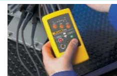
Moottoreiden pyörimissuunnan tarkistaminen ennen varsinaista kytkentää.
