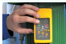
Käyvien moottoreiden pyörimissuunnan määrittäminen yksinkertaisesti asettamalla mittalaite moottorin kotelon päälle.
